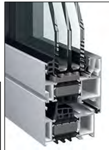
Avantis 75SHI: een geïsoleerd aluminium profielsysteem voor naar binnen opendraaiende ramen van Sapa Building System. U_w \leq 1,0 \text{ W/m}^2\text{K} .
